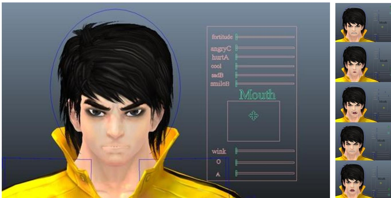
为了尽可能的达到效果和性能上的平衡，我们一个角色的表情目标体控制在8个左右。这几个不同的目标体通过我们的控制器面板实现各种融合，以达到不同的表情效果。
